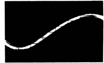
Bild 38. Nach deutlicher als im Bild 37 läßt sich die Breite der Nulldurchgänge beurteilen, wenn die x-Amplitude des Oszillografen gedehnt wird
